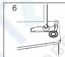
6. Открутите винт фиксатора двери
